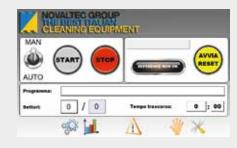
Il lavanastri automatico è dotato di un quadro comandi da 7" che permette di impostare le funzioni del nastro come lunghezza, velocità, numeri di settori, ecc.
